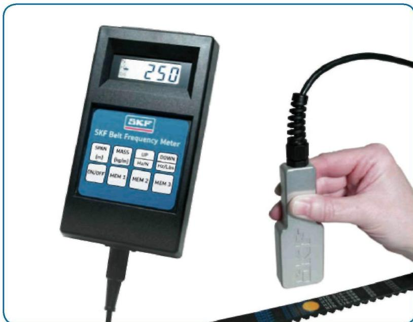
2. Расчет силы натяжения ремня. После ввода в память удельной массы ремня и длины его пролета, измеритель SKF с помощью встроенного калькулятора натяжения быстро определит и покажет на экране натяжение ремня в Ньютонах или Фунт-силах.
